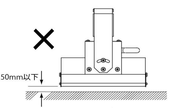
近接照射限度距離(50mm)以内での可燃物への照射
